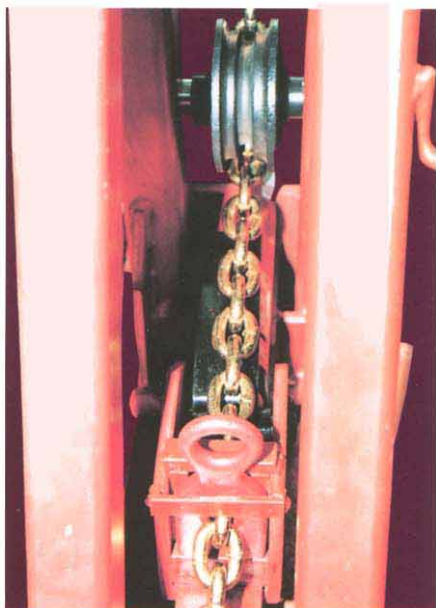
ラムストローク以上の長い引き代が必要な場合のチェーン掛け替え機構
